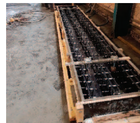
Fot. 4. Kratownica przestrzenna z metalowymi punktami stabilizującymi
