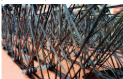
Fot. 2. Kratownica przestrzenna z włókna węglowego
