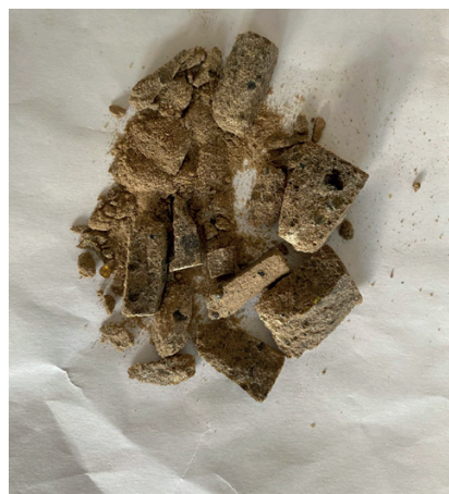
Photo 4. Fragments of sample A after its destruction Fot. 4. Fragmenty próbki A po zniszczeniu
