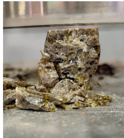
Photo 6. Fragments of sample C after its destruction Fot. 6. Fragmenty próbki C po zniszczeniu
