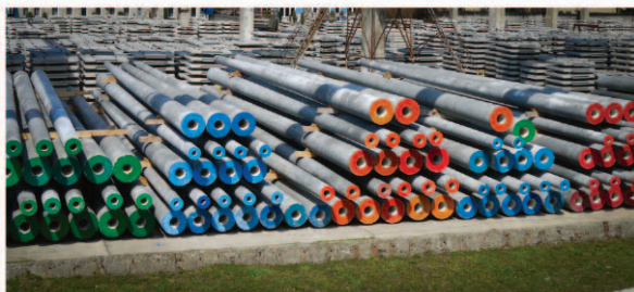
ZAKŁAD BETONÓW W KOLBUSZOWEJ - ŻERDZIE WIROWANE
