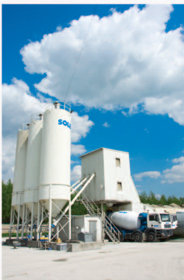
ZAKŁAD BETONÓW W LIPIU - WĘŻEL BETONIARSKI
