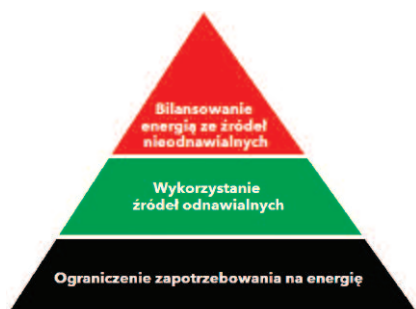
Trias energetica – koncepcja zwiększająca efektywność energetyczną budynku
