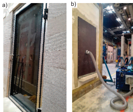
Fot. 1 Element próbny w trakcie badania przepuszczalności powietrza: a) strona zawiasowa drzwi – przeciwna do skrzyni pomiarowej; b) strona przeciwna do zawiasów drzwi – strona skrzyni pomiarowej
