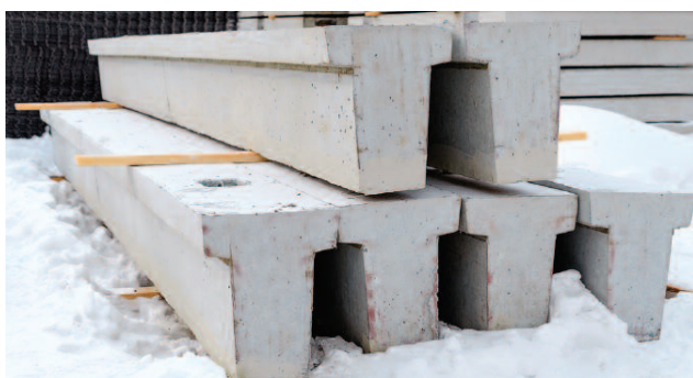
Fot. 2. Prefabrykowane belki konstrukcyjne, do produkcji których zastosowano domieszkę przyspieszającą twardnienie
