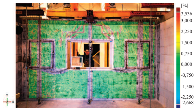
Fig. 2. Zarysowanie modelu zbrojonego siatką stalową rejestrowane za pomocą systemu optycznego
