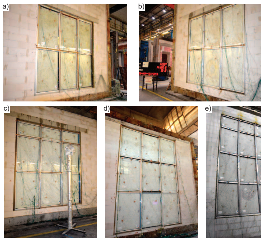
Fot. 1. Widok nienagrzewanej powierzchni elementów próbnych w trakcie badania: a) nr 1; b) nr 2; c) nr 3; d) nr 4; e) nr 5; f) nr 6 Photo 1. View of the unheated surface of the test pieces during the test: a) no. 1; b) no. 2; c) no. 3; d) no. 4; e) no. 5; f) no. 6
