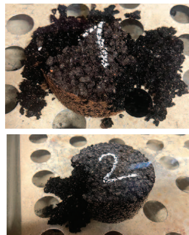
Fot. 1. Próbkę po kondycjonowaniu w wodzie o temperaturze 40^\circ\text{C}
