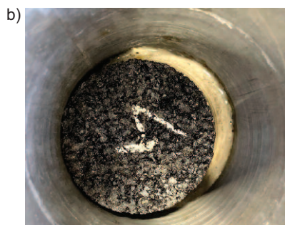
Fot. 3. Próbki po 10 cyklach zamrażania i rozmrażania zagęszczone: a) ubijaniem Marshalla; b) w prasie wytrzymałościowej
