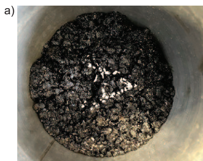
Fot. 3. Próbki po 10 cyklach zamrażania i rozmrażania zagęszczone: a) ubijaniem Marshalla; b) w prasie wytrzymałościowej
