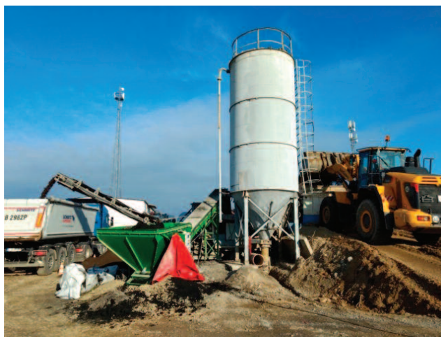
Fot. 1. Mieszarka do recyklingu „na zimno” z dozatorem miazgu gumowego w PRD Lubartów Photo 1. „Cold” recycling mixer with a rubber powder feeder in PRD Lubartów
