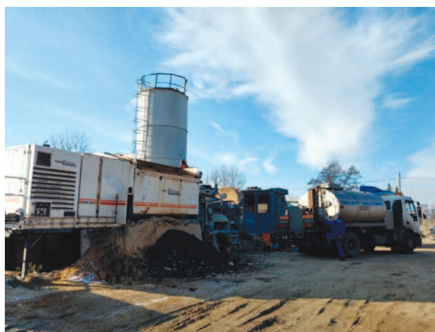
Fot. 1. Mieszarka do recyklingu „na zimno” z dozatorem miazgu gumowego w PRD Lubartów Photo 1. „Cold” recycling mixer with a rubber powder feeder in PRD Lubartów
