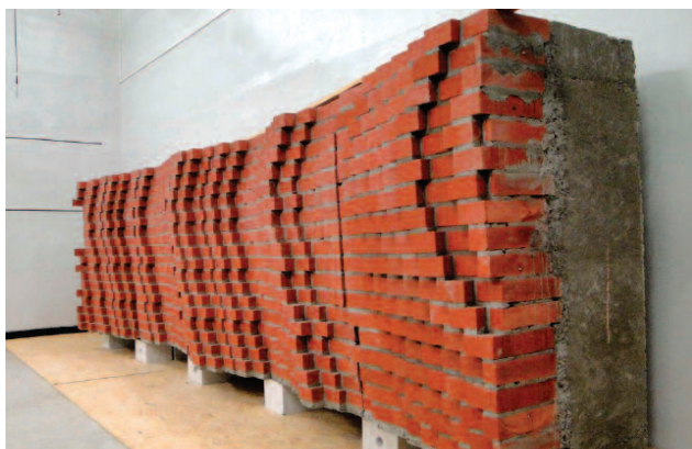
Fot. 4. Prototyp pojedynczego modułu ceglano dyfuzora (520 x 135 cm) podczas przygotowywania do badań współczynnika pochłaniania dźwięku w komorze pogłosowej w ITB
