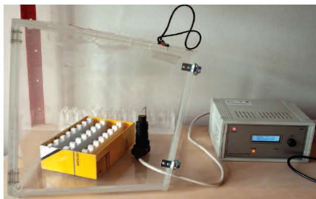
Fot. 3. Komora pogłosowa do badań modelu w skali 1 : 20 z próbką modelu widowni sali, przygotowaną do badania współczynnika pochłaniania dźwięku
