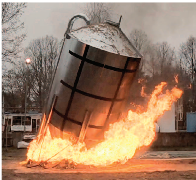
Fot. 3. Element próbny w momencie awarii Photo 3. Test specimen at collapse
