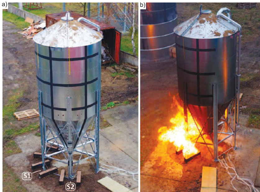
Fot. 1. Element próbny przed (a) i w trakcie (b) badania Photo 1. Test specimen prior (a) and during (b) the test
