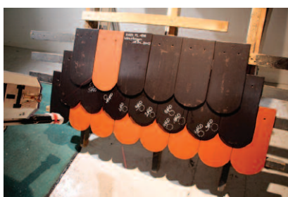
Próbka podczas wykonywania badania z zaznaczonymi punktami uderzenia i średnicą kulek lodu
