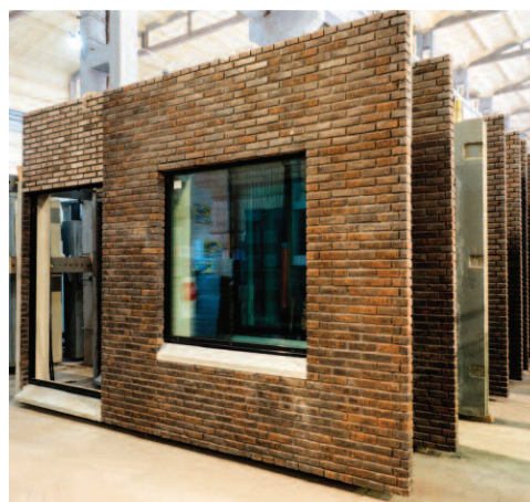
Ściana trójwarstwowa z ceglana warstwą elewacyjną – produkcja PEKABEX
