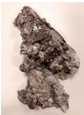
Fot. 1. Produkty stopienia: a) piany aluminiowej; b) piany aluminiowo- ceramicznej [11] Photo 1. Products of melting of: a) aluminum foam; b) aluminum-ceramic foam [11]
