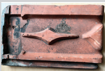
Fot. 4. Dachówka sercówka uratowana spośród dachówek zrzuconych z dachu starych koszar w Radymnie
