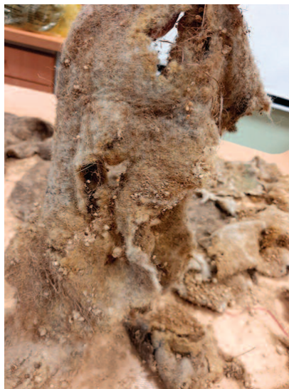
Fot. 2. Próbkę geowłókniny wełnianej umieszczonej na skarpie po pięciu miesiącach
