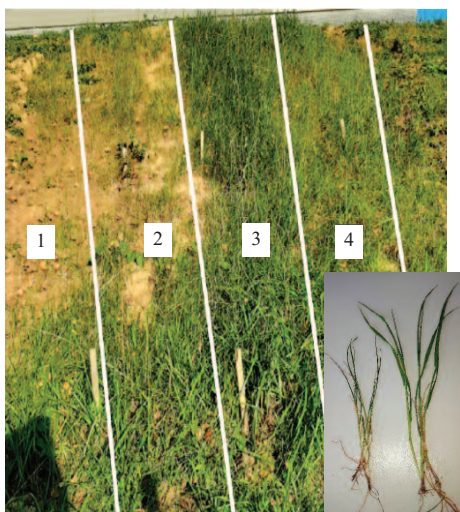
Fot. 2. Stanowisko badawcze po pięciu miesiącach od aplikacji geowłóknin: 1 – grunt „0”; 2 – geowłóknina jutowa; 3 – geowłóknina wulniana; 4 – biowłóknina RKL (wrzesień 2021 r.)
