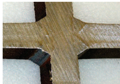
Fot. 2. Złącze krzyżowe ze spoinami pachwinowymi wykonane metodą głębokowtapijącą
