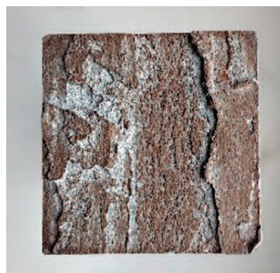
Fot. 3. Pęknięcie lamelarne prostopadle do kierunku jego propagacji
