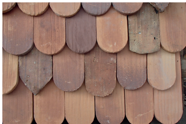
Fot. 5. Próby porównawcze dachówki odtworzeniowej (wykonanej w tradycyjnej technologii) o różnych walorach zewnętrznych z przeznaczeniem na pokrycie dachu Domu Solnego wykonane przez Heritage Roof Tiles Sp. z o.o.
