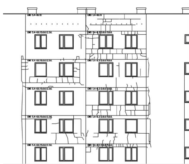
Rys. 3. Lublin 2020, fragment elewacji wschodniej budynku. Płyty GWO, typu SEG, grubości 30 cm [2]
