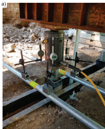
Stanowisko badawcze: a) widok głowicy mikropala i oprzyrządowania pomiarowego; b) widok ogólny
