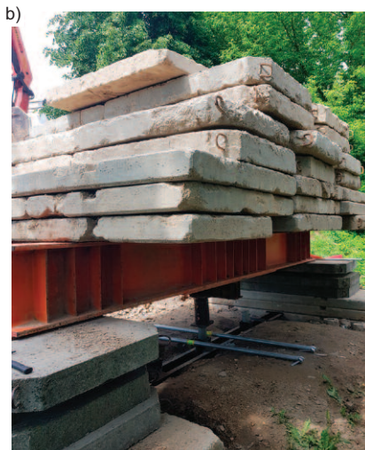
Stanowisko badawcze: a) widok głowicy mikropala i oprzyrządowania pomiarowego; b) widok ogólny
