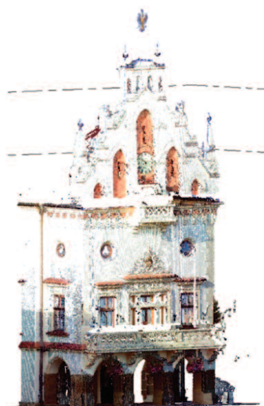
Rys. 2. Okrojona chmura punktów zaimportowana do programu Revit 2019
