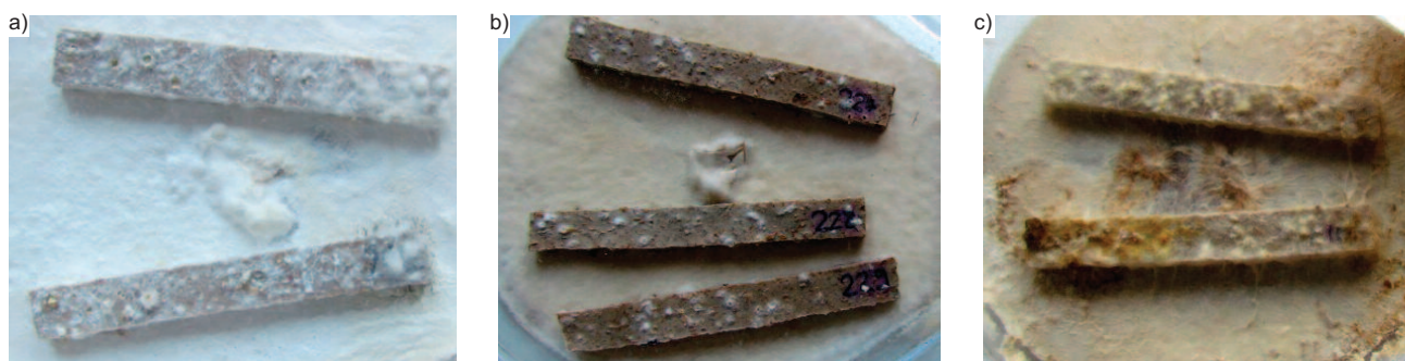
Fot. 2. Próbki kompozytu zbrojonego łuskami prosa po ekspozycji na: a) Coriolus versicolor ; b) Gloeophyllum trabeum ; c) Coniophora puteana
