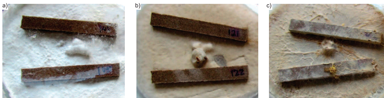
Fot. 3. Próbki kompozytu zbrojonego łuskami ryżu po ekspozycji na: a) Coriolus versicolor ; b) Gloeophyllum trabeum ; c) Coniophora puteana
