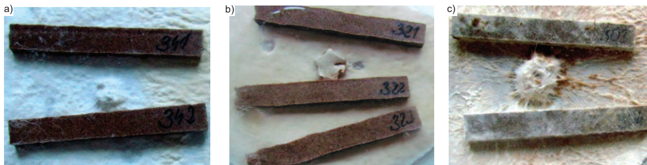
Fot. 1. Próbki kompozytu zbrojonego łuskami owsa po ekspozycji na: a) Coriolus versicolor ; b) Gloeophyllum trabeum ; c) Coniophora puteana
