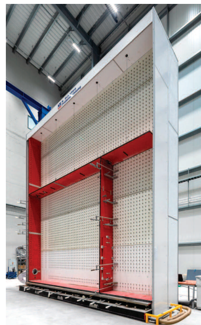
Fot. 1. Stanowisko do badania systemowej ściany osłonowej
