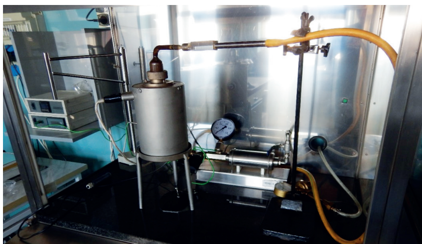
Fot. 3. Widok stanowiska do oznaczania MTZO pyłów (metoda B) Photo 3. View of the stand for determination of MTZO of dust (method B)
