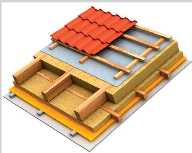
Rys. 1. Przekrój typowego w Polsce dachu budynku z poddaszem mieszkalnym. Blachodachówka (modułowa lub arkuszowa) jest uszczelniona MWK, która w tym układzie daje 5. klasę szczelności
