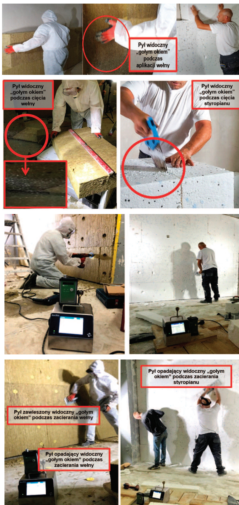
Fot. 2. Dokumentacja wizualna procesu montażu wyrobów z: wełny i styropianu w trakcie badań
