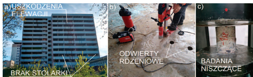
Fot. 4. Budynek nieużytkowany: a) elewacja frontowa; b) odwierty rdzeniowe; c) badania niszczące
