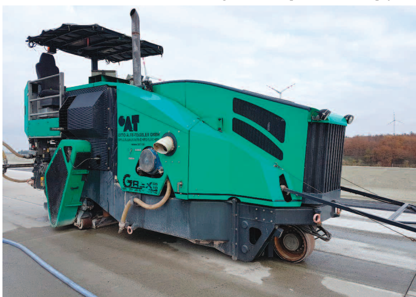
Specjalistyczny sprzęt do wykonywania nawierzchni metodą grinding
