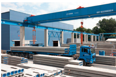
Fot. 1. Magazyn prefabrykowanych płyt stropowych w zakładzie prefabrykacji Betard
