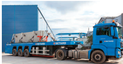
Fot. 2. Transport ścian prefabrykowanych zweryfikowanych przez kierowcę
