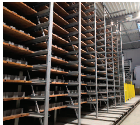
System regalowy do dojrzewiania prefabrykowanych elementów betonowych
