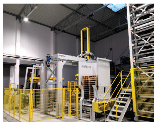
Paletyzacja prefabrykowanych elementów betonowych
