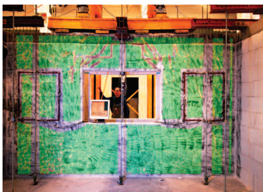
Zarysowanie modelu BKOZSS-1 rejestrowane za pomocą systemu optycznego
