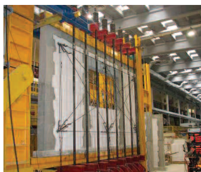
Fot. 5. Badania ścian skrępowanych prowadzone na Politechnice Śląskiej
