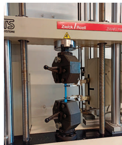
Fot. 1. Maszyna wytrzymałościowa wykorzystywana do próby statycznego rozciągania
