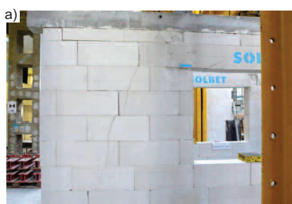
Fot. 3. Zarysowanie modeli z nadprożem z ABK: a) MNSO-Z1-1; b) MNSO-Z1-2
