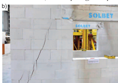
Fot. 3. Zarysowanie modeli z nadprożem z ABK: a) MNSO-Z1-1; b) MNSO-Z1-2
