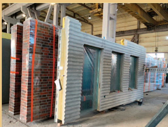
Ściana typu sandwich, w której zastosowano kotwy Schöck Isolink®
