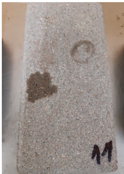
Fot. 4. Pozostałości zabrudzeń po zmyciu i wyschnięciu powierzchni próbki zaimpregnowanej preparatem na bazie silanów
