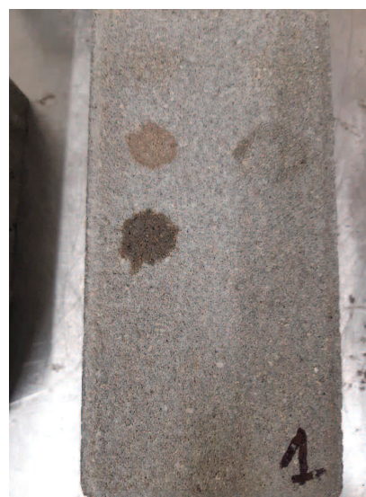
Fot. 2. Pozostałości zabrudzeń po zmyciu i wyschnięciu powierzchni próbki referencyjnej
