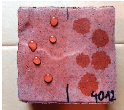
Fot. 5. Efekt impregnacji kostki barwionej
