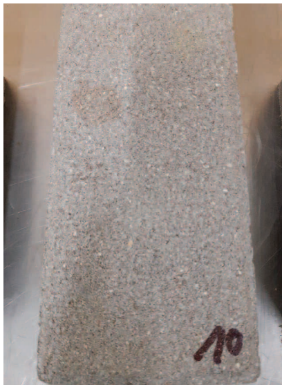
Fot. 3. Pozostałości zabrudzeń po zmyciu i wyschnięciu powierzchni próbki zaimpregnowanej preparatem na bazie roztworu żywicy akrylowej
