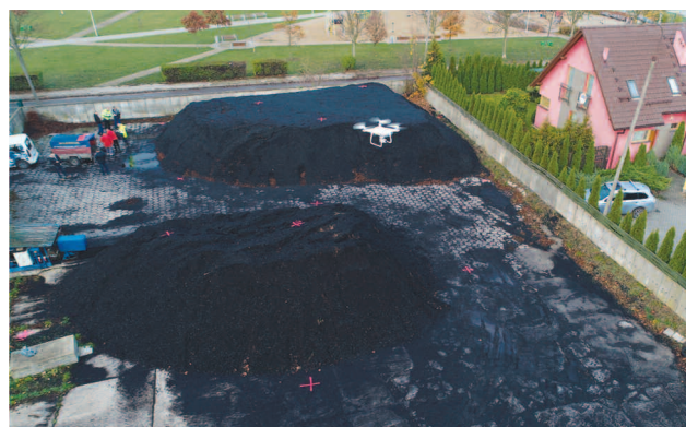
Fot. 2. Dron podczas pomiaru hałd – przykład wykorzystania fotogrametrii
