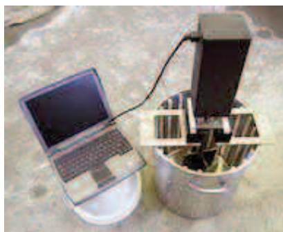
Fot. 1. Określenie lepkości plastycznej za pomocą aparatu Rheometr ICAR
