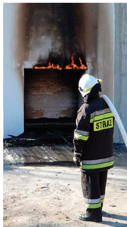
Ogień wydobywający się ze strefy pasa z wełny po zakończeniu badania i ugaszeniu źródła ognia
