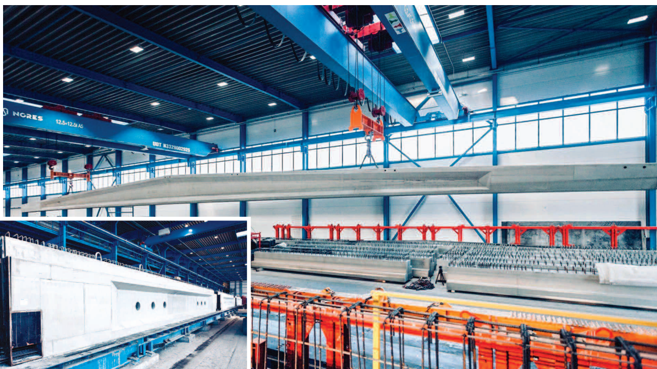
Fot. 3. Linia produkcyjna dźwigarów sprężonych
