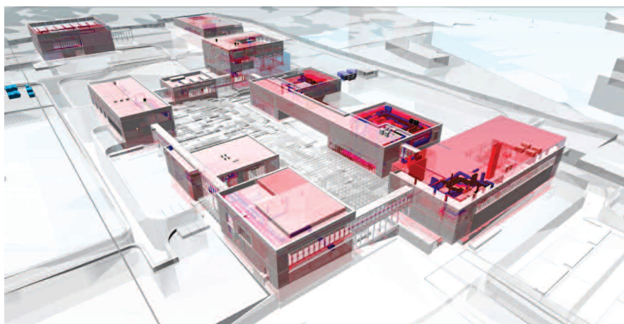
Ry. 3. Wielobranżowy model BIM Kampusu Głównego Urzędu Miar w Kielcach (materiały autorskie BDM'A)
