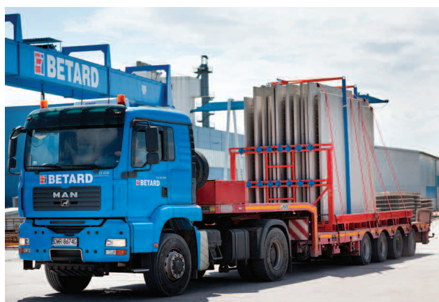
Fot. 3. Transport ścian zespolonych
