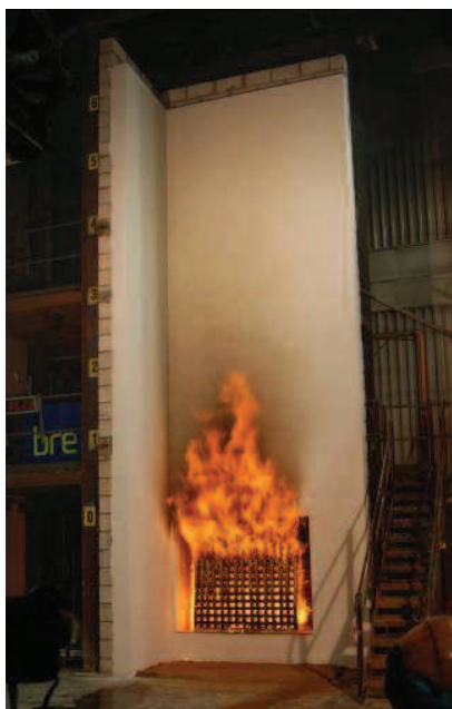
Fot. 2. Badanie zgodnie z normą brytyjską BS 8414-1:2002
