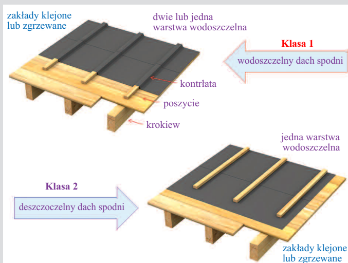
Rys. 1. Dwa rodzaje „dachów spodnich” („dachem spodnim” określa się typ warstwy wstępnego krycia z materiałów hydroizolacyjnych). Takie uszczelnienia pokryć leżących na łatach stosuje się w przypadku bardzo małego nachylenia połaci
