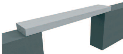
Rys. 4. Nadproże sprężone PLX
