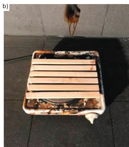
Ułożenie próbek drewna podczas spalania: a) płomieniowego; b) bezpłomieniowego Arrangement of wood samples during combustion: a) flame; b) flameless
