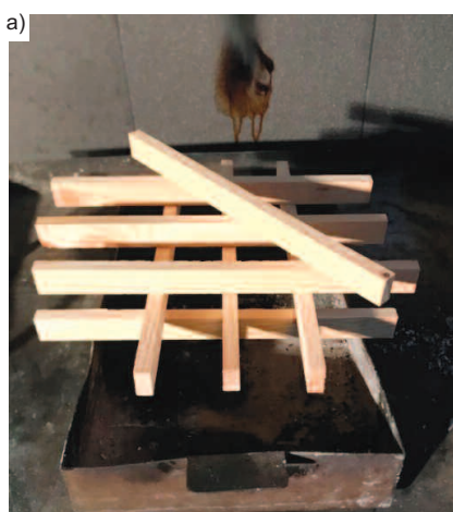
Ułożenie próbek drewna podczas spalania: a) płomieniowego; b) bezpłomieniowego Arrangement of wood samples during combustion: a) flame; b) flameless
