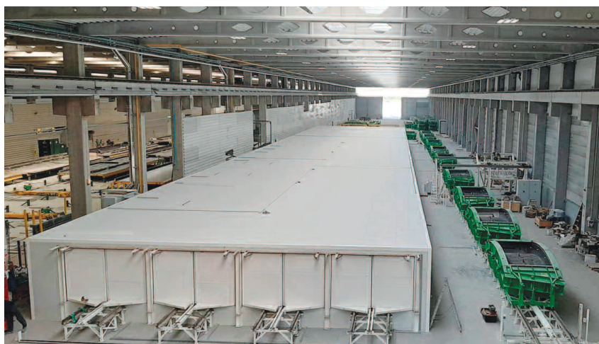
Fot. 1. Fragment linii do produkcji tubingów w fabryce spółki Pekabex Bet w Mszczonowie
