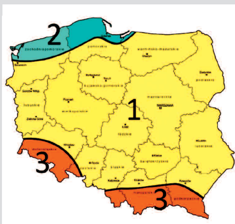
Rys. 1. Podział Polski na strefy wiatrowe opracowane wg PN-EN 1991-1-4:2008P. Rysunek publikowany w Zeszyty nr 3 Wytycznych Dekarskich PSD
