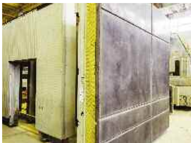
Element prefabrykowany z warstwą wykończeniową uzyskaną za pomocą dwóch różnych matryc do betonu (od lewej) oraz element prefabrykowany z warstwą konstrukcyjną, izolacyjną i wykończeniową (od prawej)
