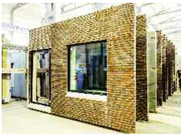
Prefabrykowane trójwarstwowe ściany z zamontowaną stolarką okienną składowane w zakładzie prefabrykacji betonu
